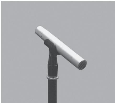
Als ein Beispiel für viele die *Stäbchen* der Firma Schoeps. Die (austauschbaren) Kapseln gibt es mit verschiedenen Richtcharakteristiken. Die speziellen hier verwendeten Kapseln mit Kugelcharakteristik weisen nach vorn – also auf die Schallquelle zu – einen geraden Frequenzgang auf, im Gegensatz zu den meisten „Kollegen“, die von vorne die hohen Frequenzen bevorzugen.
