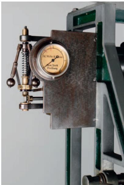
Der Drehzahlmesser an der Aufnahmespule des Aufnahmeapparats. The revolution counter on the recording reel of the recording device. Le compte-tours sur le rouleau d'enregistrement de l'appareil enregistreur.
